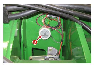
**B** - Slope Sensing Clinometer
