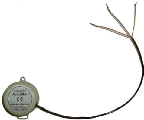
#3 LA-255821 EM CABLE ASM, CLINOMETER
